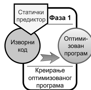
Слика 3: Оптимизација програма коришћењем статичког предиктора профила
