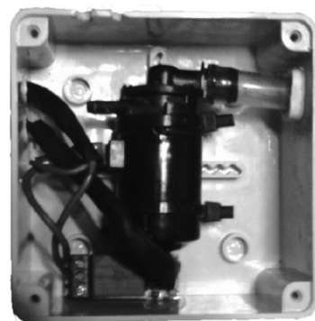
Slika 9: Električna pumpa za vodu i relejni modul u kućištu
