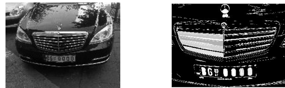
Slika 7 a), b) i c): Detekcija u slučaju iskošenih tablica, izbor srtakturnog elementa prilikom erozije i dilatacije da bi se jasnije razlikovali karakter G i cifra 6
