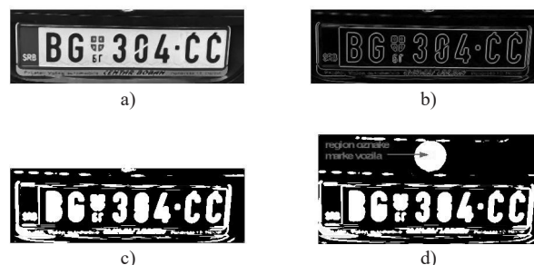
Slika 3: a) Uklanjanje šuma Median filtrom b) Izdvajanje ivica Sobelovim detektorom c) Rezultat primene operacije erozije i dilatacije d) Eliminacija oblasti regiona oznake marke vozila
