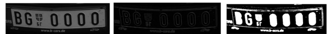
Slika 8 a), b), c), d) i e): Detekcija u slučaju postojanja karaktera O i cifre 0, uz eliminaciju oznake marke vozila Mercedes
