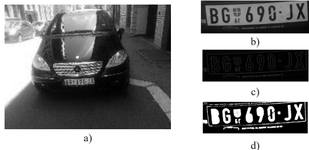
Slika 9 a), b), c) i d): Detekcija u slučaju vozila u pokretu (prilikom parkiranja), uz primenu Motion Blur filtra
