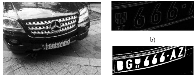
Slika 7 a), b) i c): Detekcija u slučaju iskošenih tablica, izbor srtakturnog elementa prilikom erozije i dilatacije da bi se jasnije razlikovali karakter G i cifra 6
