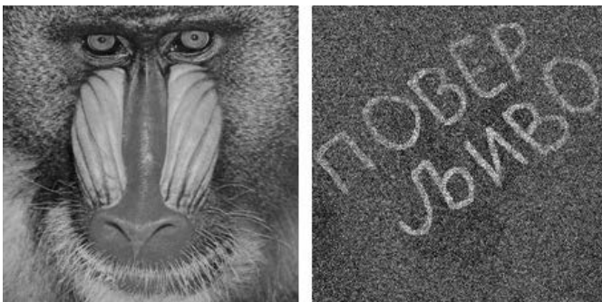
Слика 7 – Слика лијево је добијена након уметања воденог жига у оригиналну слику ( \alpha=0.01 ) и примјене ЈПГ компресије са q=80 . Слика десно је примјер извученог воденог жига из десне слике.
